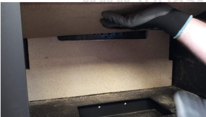
Posar los deflectores en el fondo de la cámara de combustión y quitar antes el deflector superior y luego el deflector inferior
