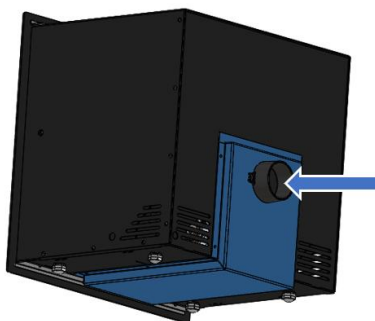
Figura nº8 - Accesorio para canalizar la entrada de aire desde la parte trasera
