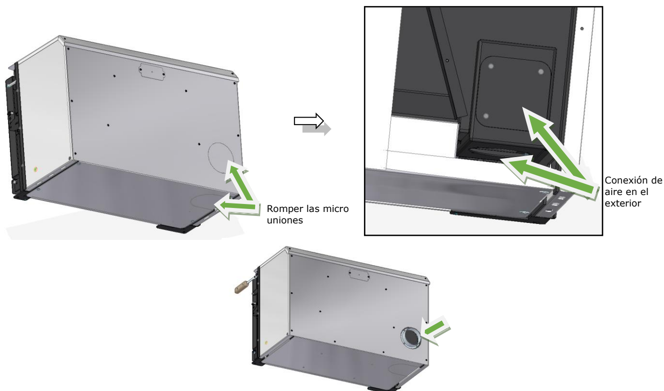
Figura 21 – Posibilidades de conexión con el equipo "Kit de toma de aire exterior"
