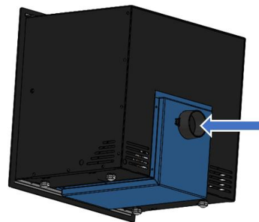
Figura n°13 - Accesorio para canalizar la entrada de aire desde la parte trasera
