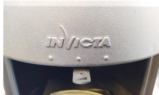
Figure n°15 - Position du registre d'arrivée d'air pour la puissance thermique nominale
