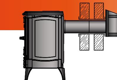
Algunos modelos están diseñados para instalación con salida horizontal trasera (sujeto a las leyes y regulaciones locales).
