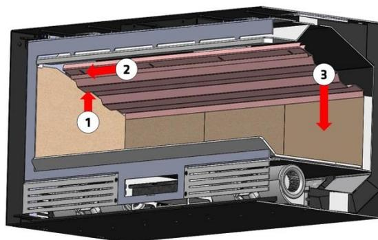
Figura n°20 - Desmontaje del deflector.
