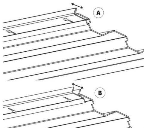
Figura n°19 - Diferentes posiciones del deflector inferior SILVER
